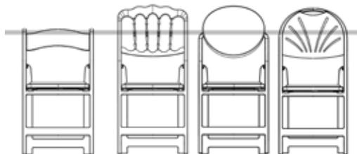
**MATERIAL:** Mehrlagen-Kunststoffverbund, Edelstahl-Schrauben. Rastbarer, 6 mm starker Klappsitz aus Kunstharz mit Schaumstoffauflage und PVC-Bezug, schwer entflammbar (CAL 117).
